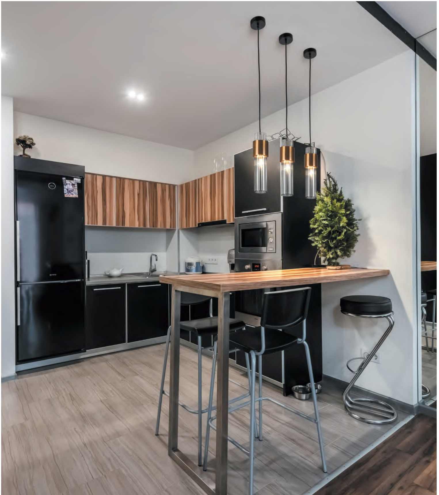
Арматура из металла черного цвета. Плафон — прозрачное ребристое стекло цилиндрической формы. Декоративная металлическая вставка золотого оттенка. Источник света — лампа с цоколем E14.
